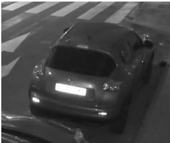
Abb. 15: Überbelichtete Kennzeichen aufgrund zu starken IR-LED-Lichts
