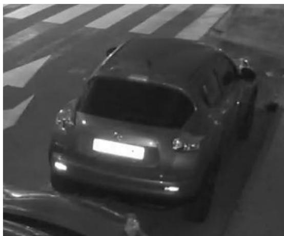
Fig. 15: Plaques d'immatriculation surexposées à cause d'une LED IR trop forte
