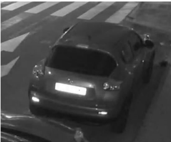
Abb. 17: Überbelichtete Kennzeichen aufgrund zu starken IR-LED-Lichts
