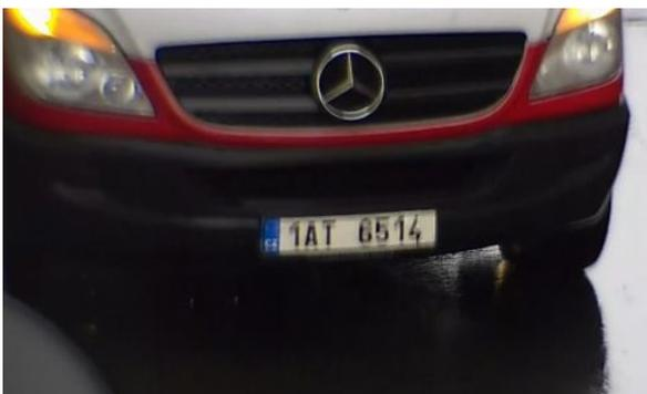
Abb. 15: Unscharfes Kennzeichen aufgrund langer Belichtungszeit
