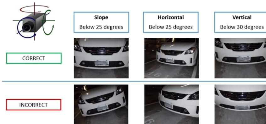
Abb. 11: Maximaler Drehungswinkel
