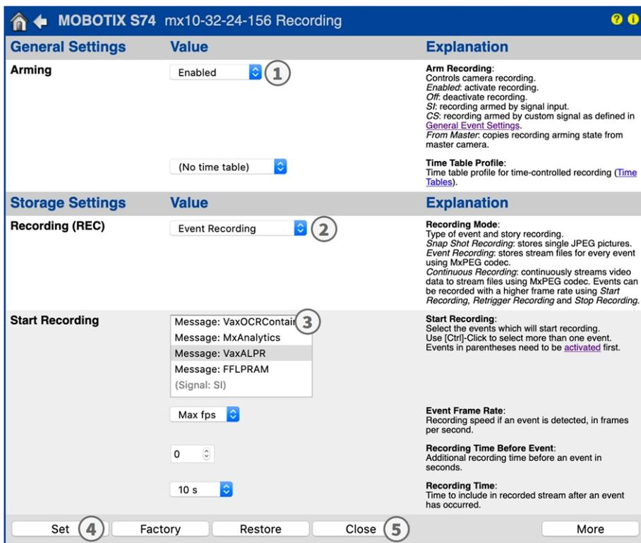
Fig. 28: Configurazione delle impostazioni di registrazione della telecamera
