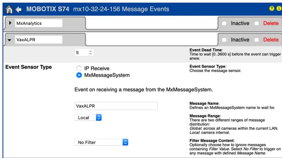
Fig. 24: Esempio: Dettagli evento messaggio generico - senza filtro
