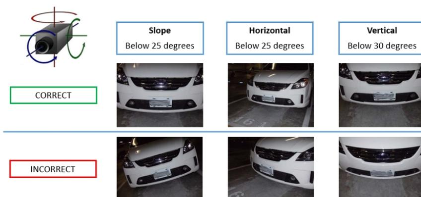
Fig. 11: Angolo di rotazione massimo
