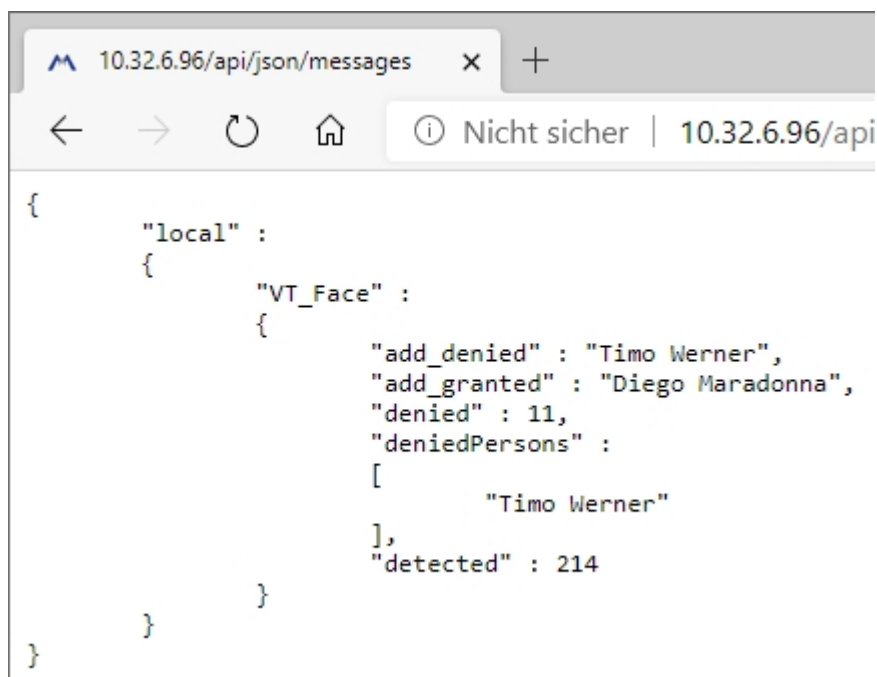
Fig. 19: Exemple : Métadonnées transmises dans un message MxMessage de Visage Technologies Face Recognition App
