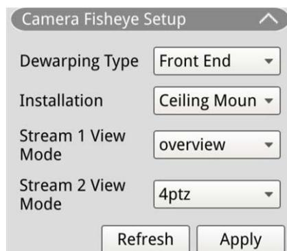
El NVR permite a los usuarios ajustar el tipo de corrección de la deformación entre Back End Dewarping (corrección de la deformación de Back End) y Front End Dewarping (Corrección de la deformación de Front End), en función del DSP de la cámara. Seleccione el canal de la cámara con ojo de pez y haga clic en **Camera FishEye Setup** (Configuración de ojo de pez de la cámara) a la izquierda para mostrar la configuración.
