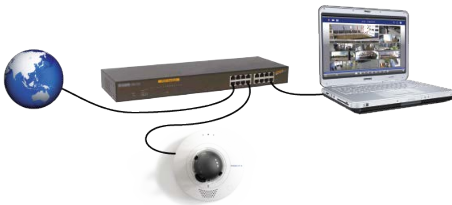
Abb. 15: Stromversorgung über PoE-Switch gemäß PoE Plus (802.3at-2009).
