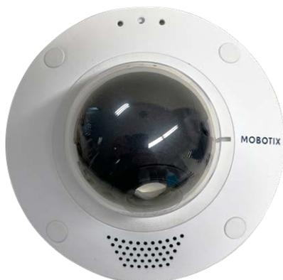
2. Afloje los cuatro tornillos de fijación del anillo de sujeción con la llave Allen [Materiales de montaje: Alcance de la entrega](#), p. 18 suministrada y, a continuación, tire con cuidado de la cúpula.
