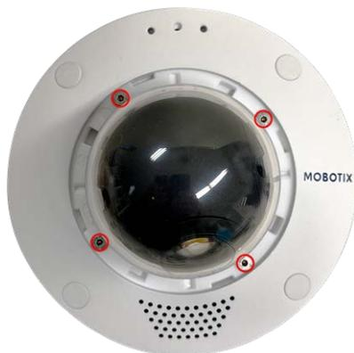
3. Afloje ligeramente los dos tornillos Allen con la llave Allen [Materiales de montaje: Alcance de la entrega, p. 18](#) en ambos lados del soporte del objetivo.
