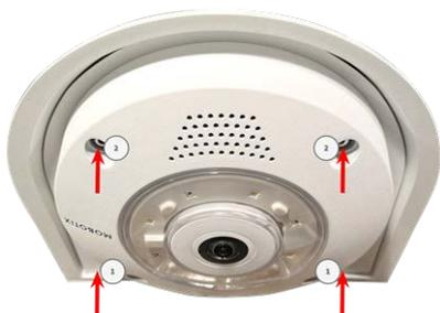
11. Introduzca los tapones de caucho M.7, p. 18 en los agujeros para tornillos de la cámara (① y ② en la figura anterior).
