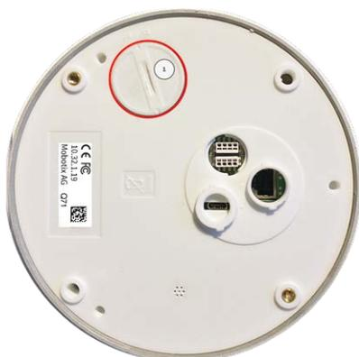
3. **Desbloquee el soporte de la tarjeta microSD:** Levante con cuidado la cubierta metálica ② de la tarjeta microSD (por ejemplo, con la uña).
