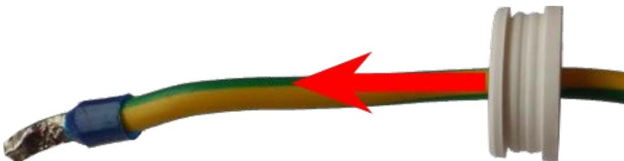
Abb. 60: Masseleitung mit einadrigem Gummistopfen C.4
