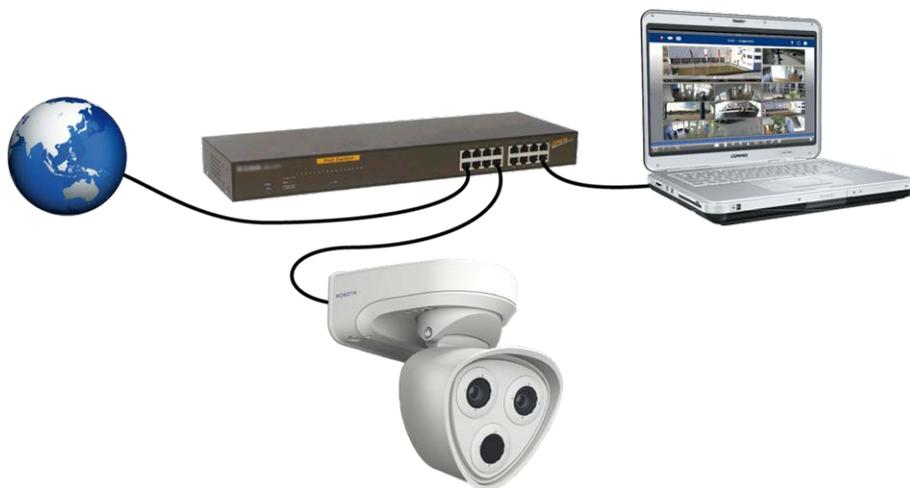
Abb. 51: Stromversorgung über PoE-Switch gemäß PoE Plus (802.3at-2009).
