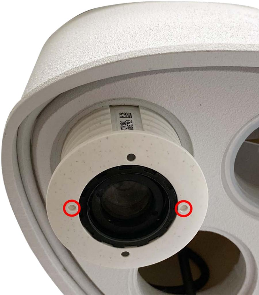
Abb. 12: Sensormodul in Modulgehäuse einsetzen
