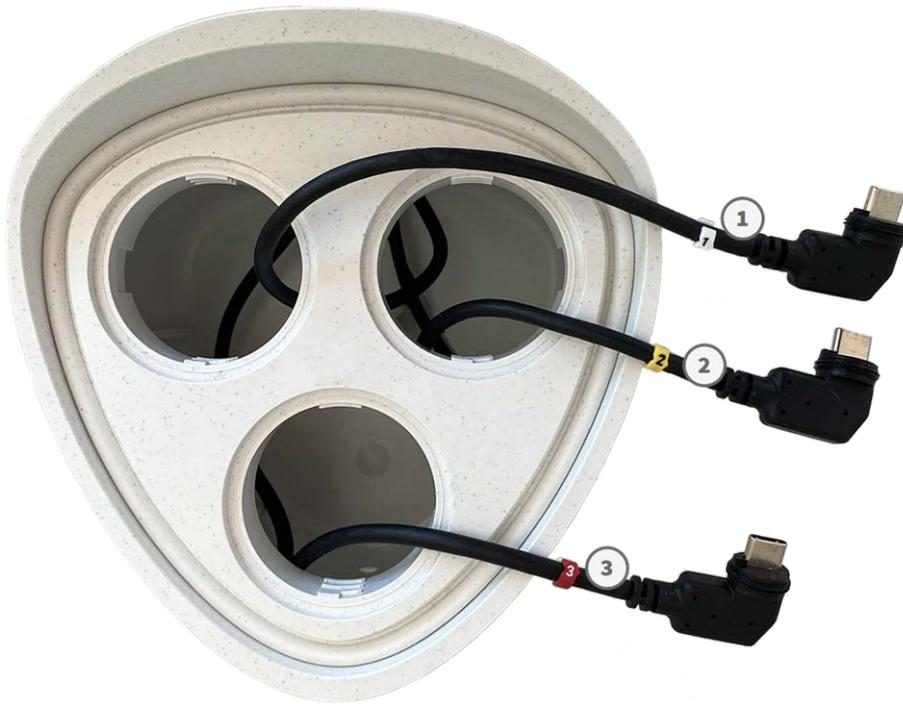
Abb. 8: Nummerierte Sensormodulkabel
