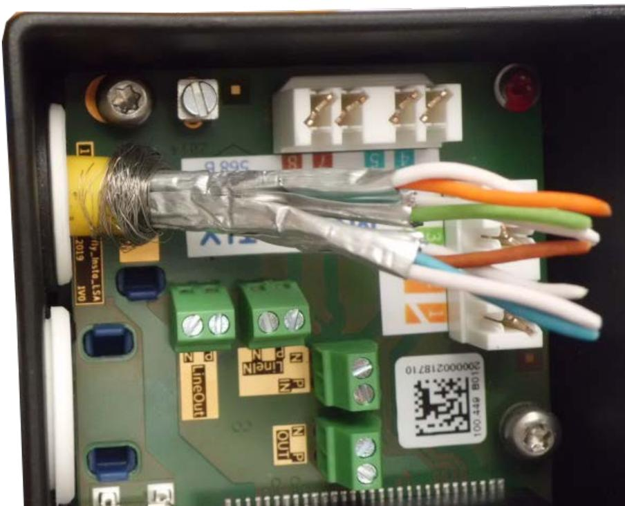
Abb. 56: Netzkabel eingesteckt, Stopfen richtig eingesetzt
