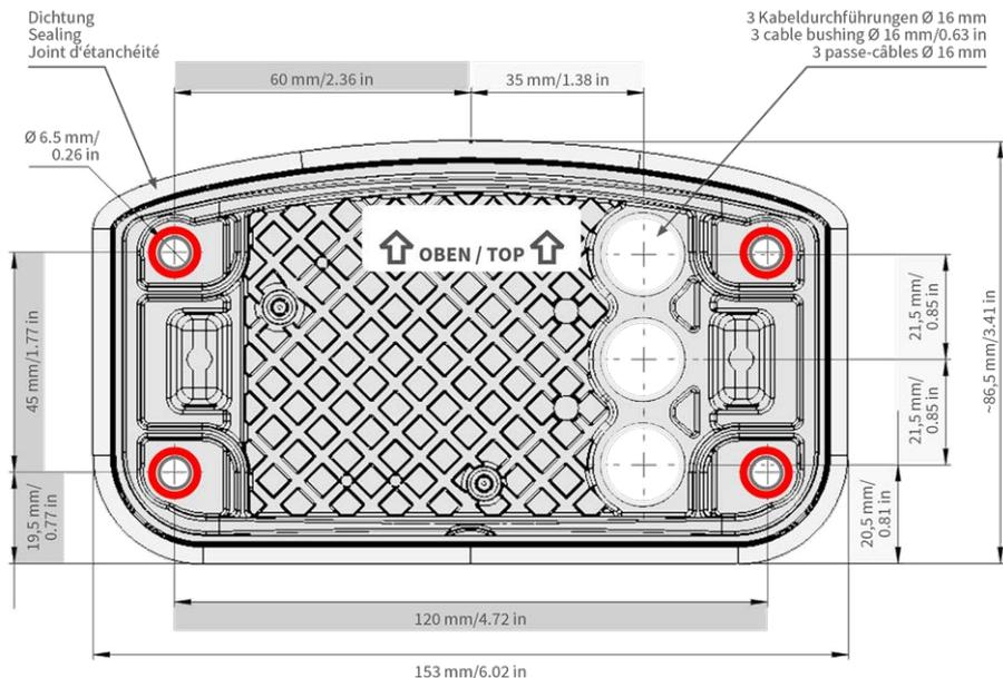
Abb. 30: Montageplatte mit Bohrungen zur Positionierung der Befestigungsschrauben
