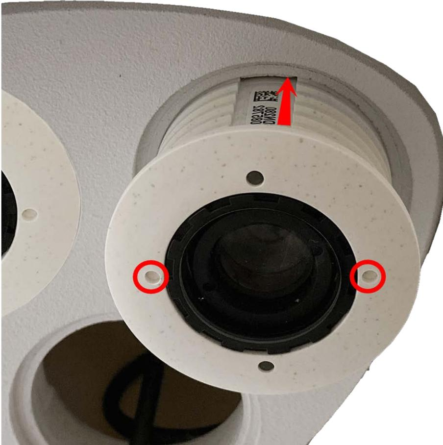
Abb. 25: Sensormodul in Thermal-Frontplatte einsetzen
