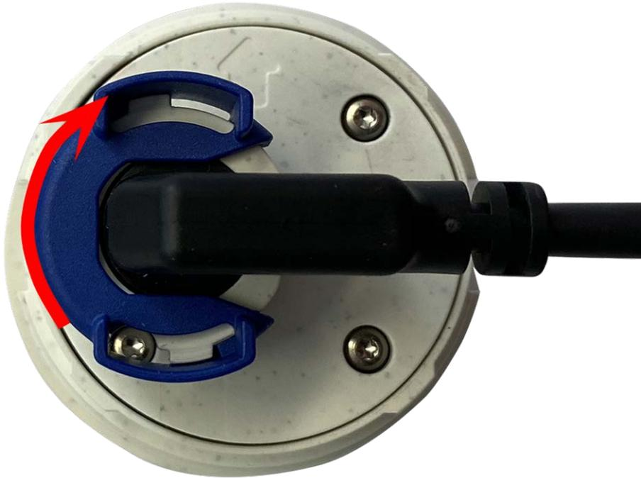
Abb. 11: Sensormodul verriegeln
