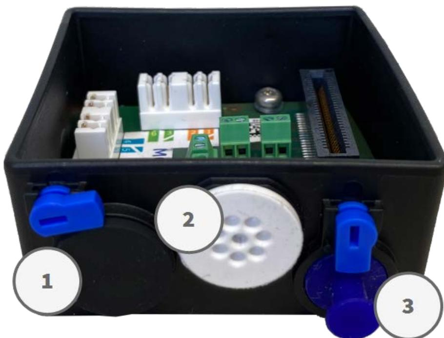
Abb. 34: Connector Box LSA
