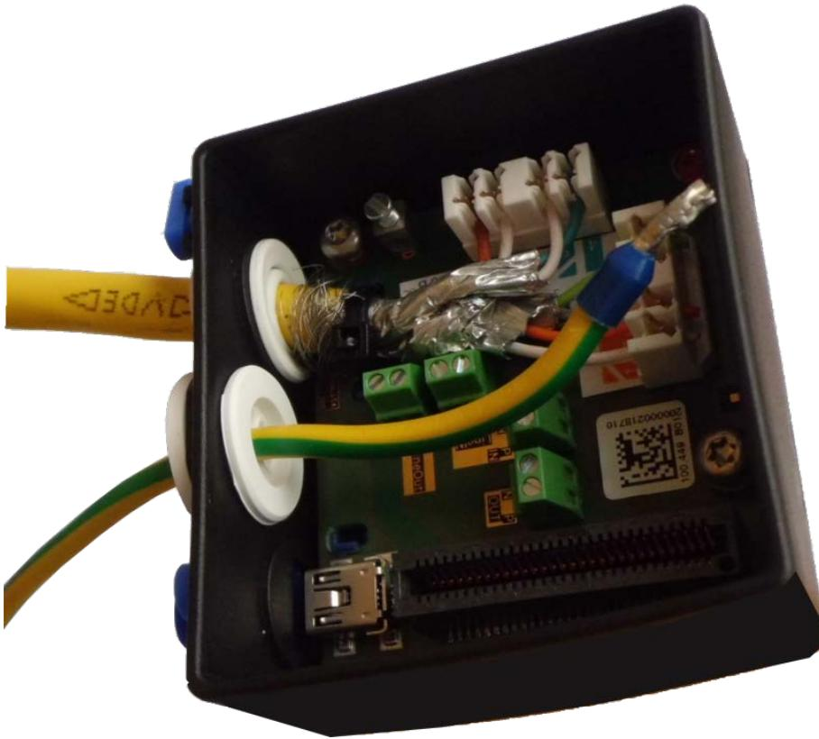
Abb. 61: Masseleitung eingesteckt, Stopfen richtig eingesetzt
