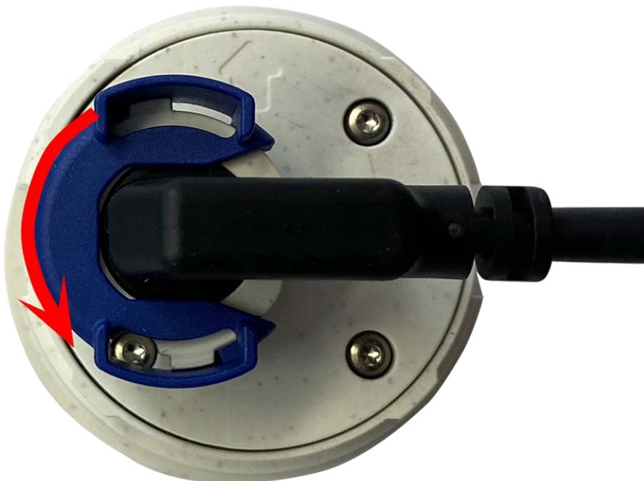
Fig. 20: Desbloqueo del cable del módulo de sensor
