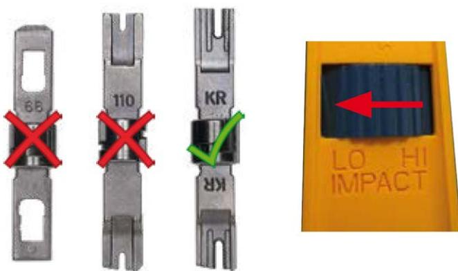
Fig. 58: Herramienta LSA+/Krone ajustada a un impacto BAJO
