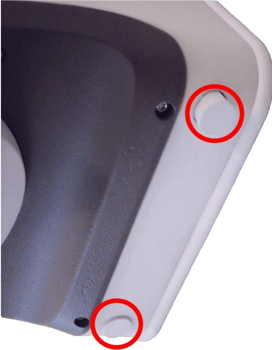
Fig. 89: Retire los tapones de caucho
