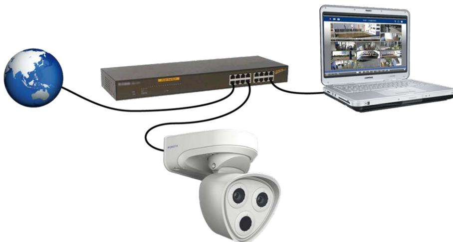
Fig. 51: Fuente de alimentación mediante un conmutador PoE según la PoE Plus (802.3at-2009)
