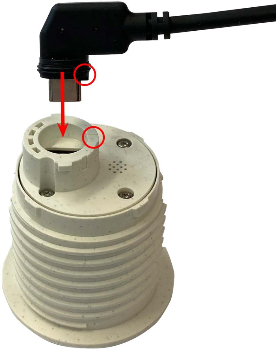
Fig. 27: Conecte el cable del módulo del sensor
