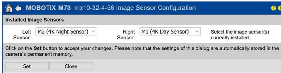
Fig. 87: Configuración de los módulos del sensor
