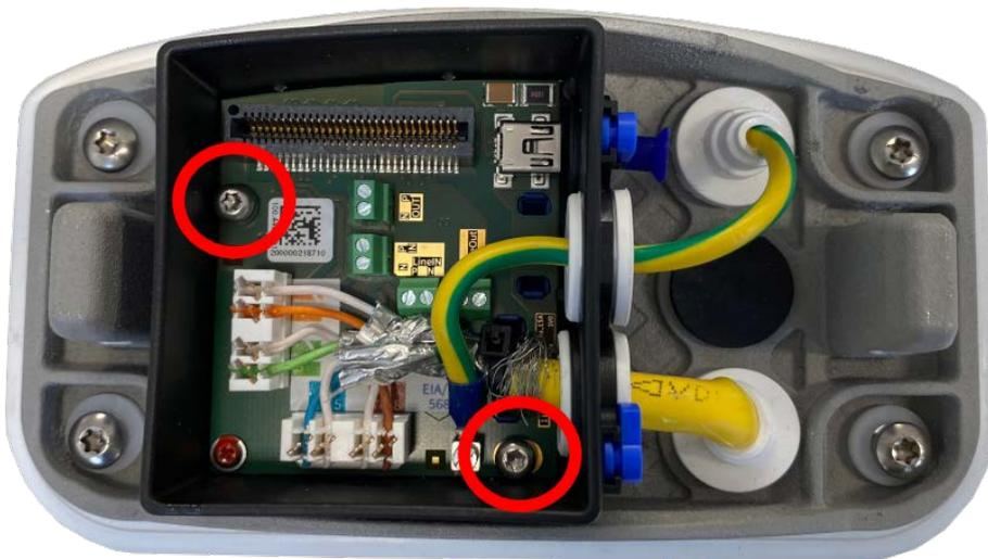
Fig. 63: Monte el Connector Box LSA (imagen superior) con los dos tornillos (resaltados en rojo) en la placa de montaje
