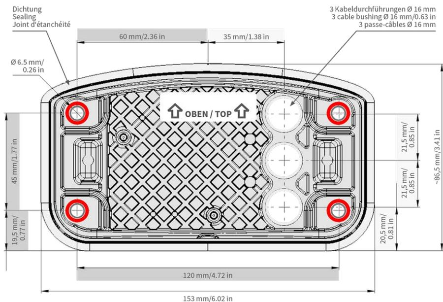
Fig. 30: Placa de montaje con agujeros para colocar los tornillos de fijación
