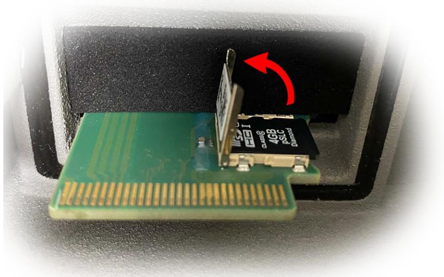
Fig. 93: Desbloquee el soporte de la tarjeta microSD
