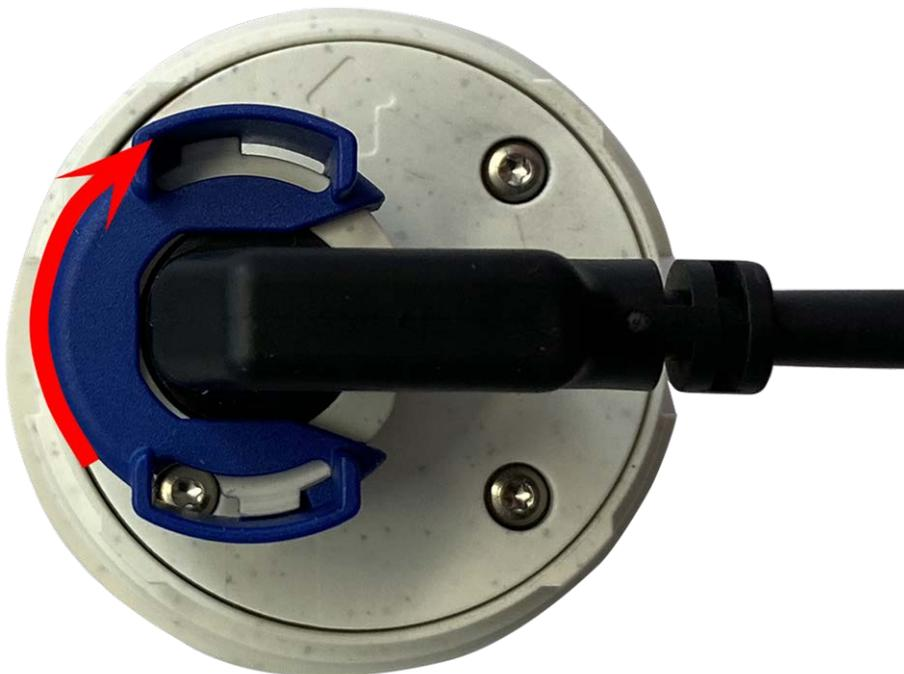
Fig. 11: Bloquee el módulo de sensor
