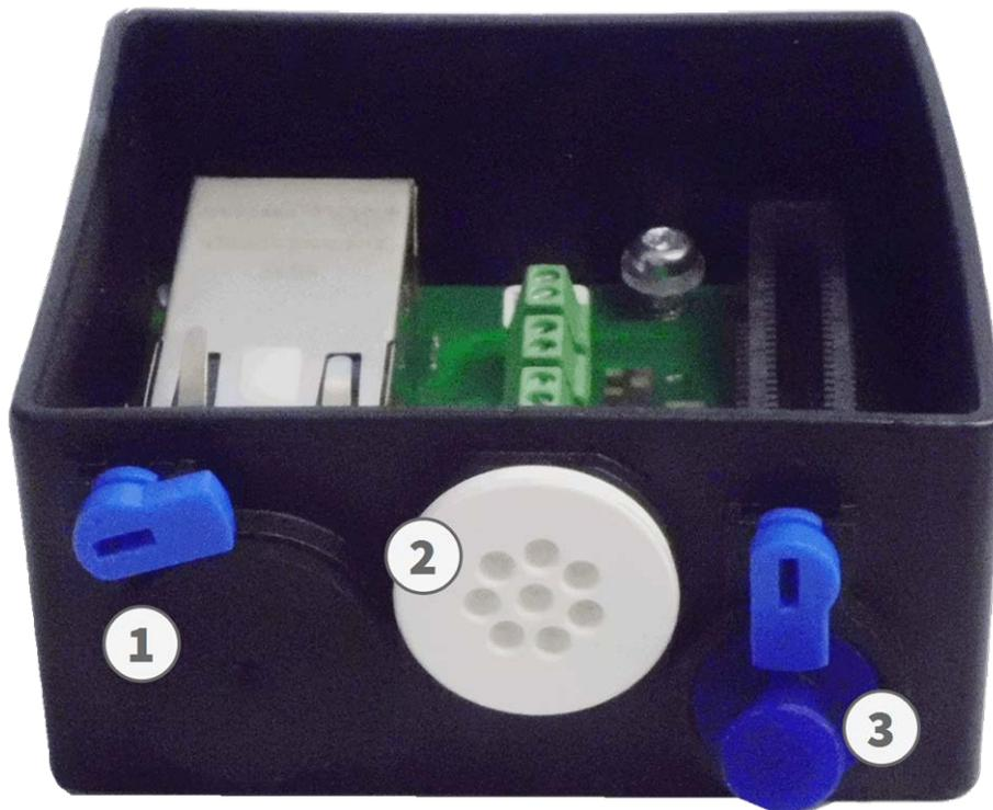
Fig. 64: Connector Box RJ45 con tapón de caucho negro C.3 ①, tapón de caucho de un solo cable C.4 ②, tapón para USB ① y dos cierres azules
