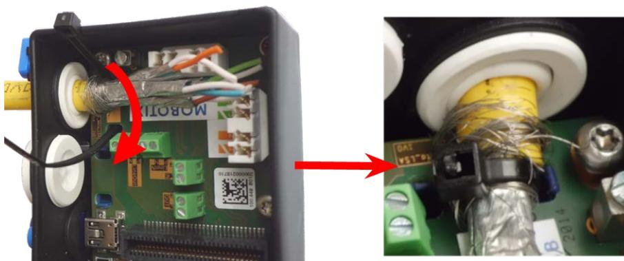
Fig. 57: Breda introducida debajo del cable de red
