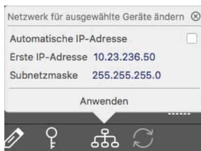
**Fig. 79: Cambiar red para los dispositivos seleccionados**
