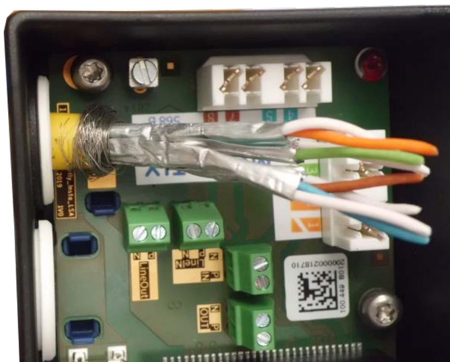
Fig. 56: Câble réseau inséré, bouchon correctement installé
