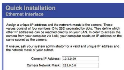
Fig. 77: Paramètres réseau dans l'interface Web de la caméra
