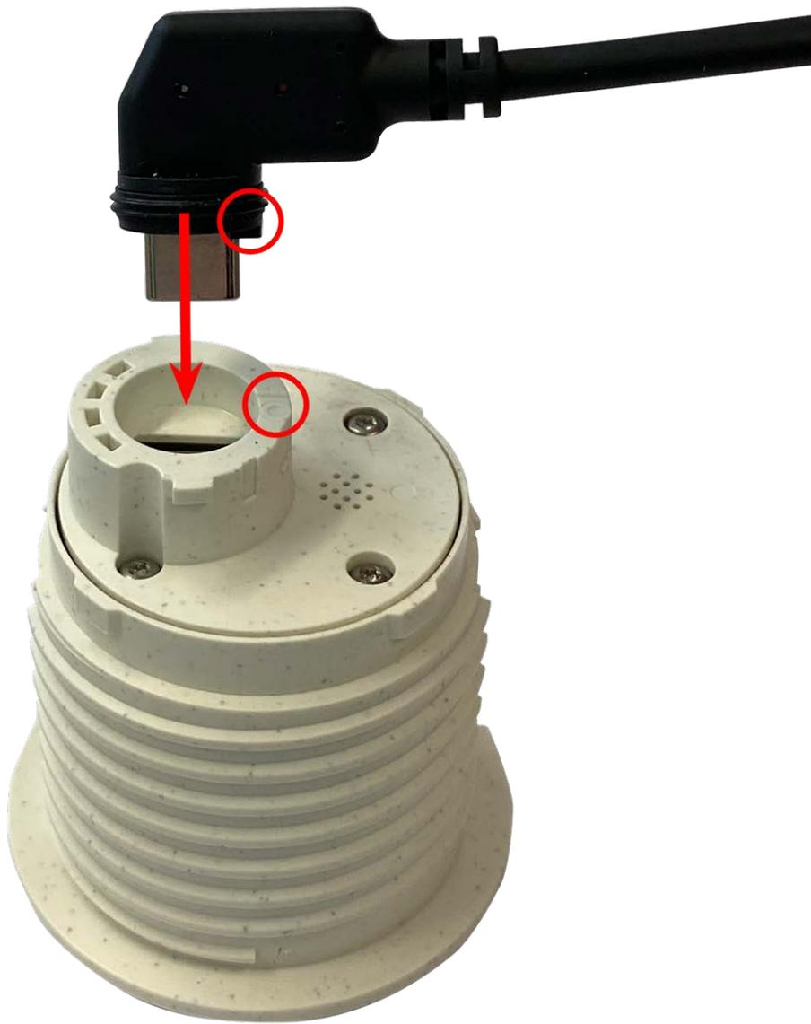
Fig. 27: Branchement du câble du module de capteur
