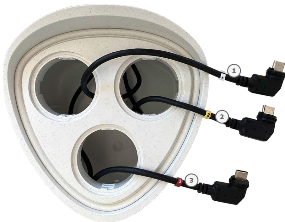
Fig. 8: Câbles du module de capteur numérotés
