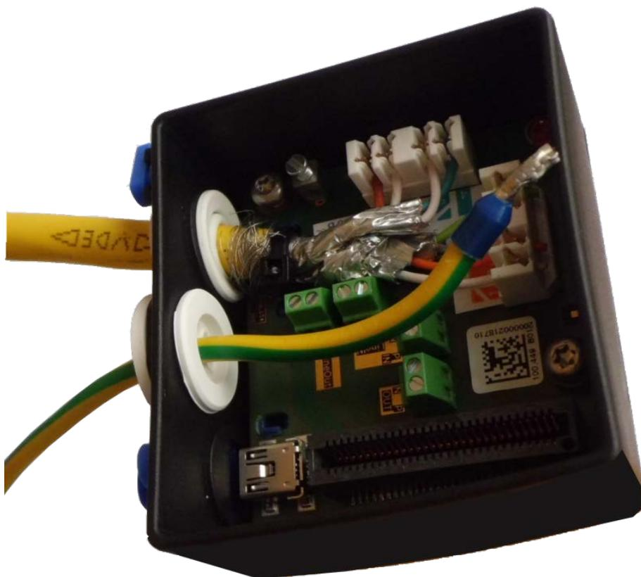
Fig. 61: Fil de terre inséré, bouchon correctement installé
