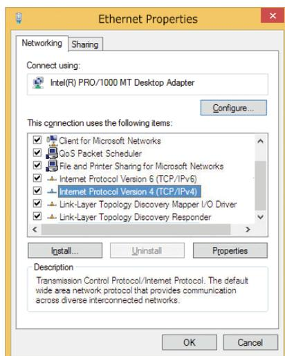
Fig. 74: Paramètres réseau sur des ordinateurs Windows
