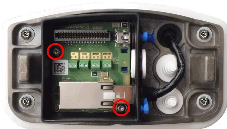
Fig. 66: Montez le Connector Box RJ45 (vue de dessus) à l'aide des deux vis (surlignées en rouge sur la figure) sur la plaque de montage
