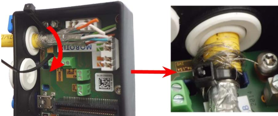
Fig. 57: Serre-câble inséré sous le câble réseau
