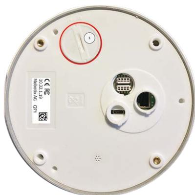
3. **Sbloccare il supporto della scheda microSD:** Sollevare con cautela il coperchio metallico ② della scheda microSD (ad esempio, con un'unghia).
