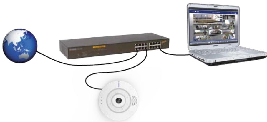
Fig. 15: Alimentazione tramite interruttore PoE in base allo standard PoE Plus (802.3at-2009).
