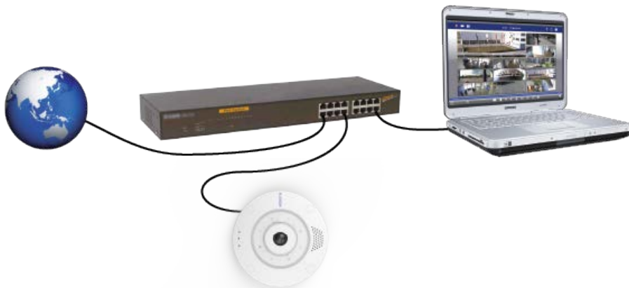
Fig. 15: Alimentation électrique à l'aide d'un commutateur PoE conformément à PoE Plus (802.3at-2009).
