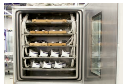
Antes de la entrega se comprueba la resistencia a temperaturas extremas de la cámara.
