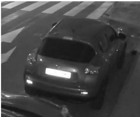
Abb. 17: Überbelichtete Kennzeichen aufgrund zu starken IR-LED-Lichts
