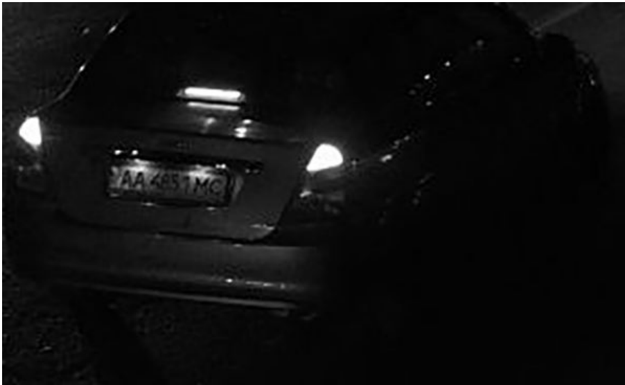
Abb. 18: Unzureichende Lichtverhältnisse zur Erkennung des Kennzeichens
