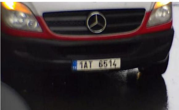
Abb. 15: Unscharfes Kennzeichen aufgrund langer Belichtungszeit
