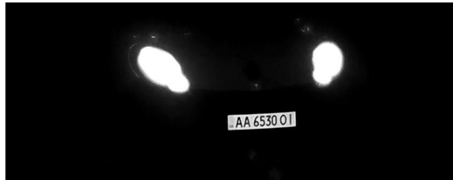
Abb. 11: Gut lesbares Kennzeichen bei Nacht mit Infrarot-LED-Beleuchtung
