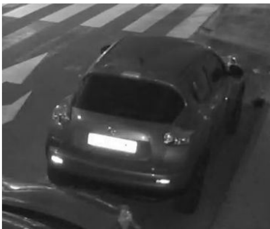
Fig. 17: Matrícula sobreexpuesta debido a luz LED IR demasiado intensa
