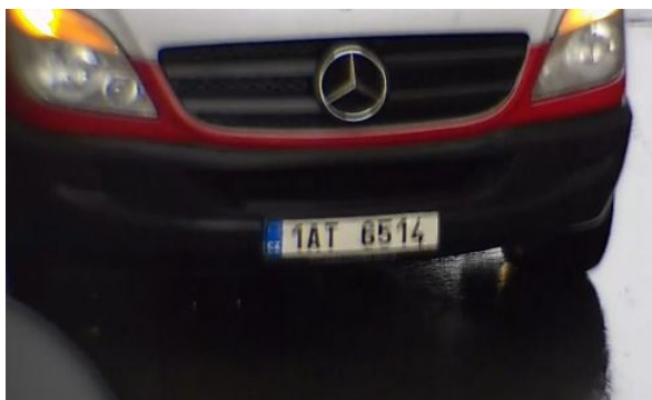
Fig. 15: Matrícula borrosa debido a un tiempo de exposición largo
