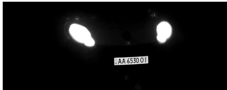
Fig. 11: Matrícula fácilmente legible por la noche con iluminación LED infrarroja
