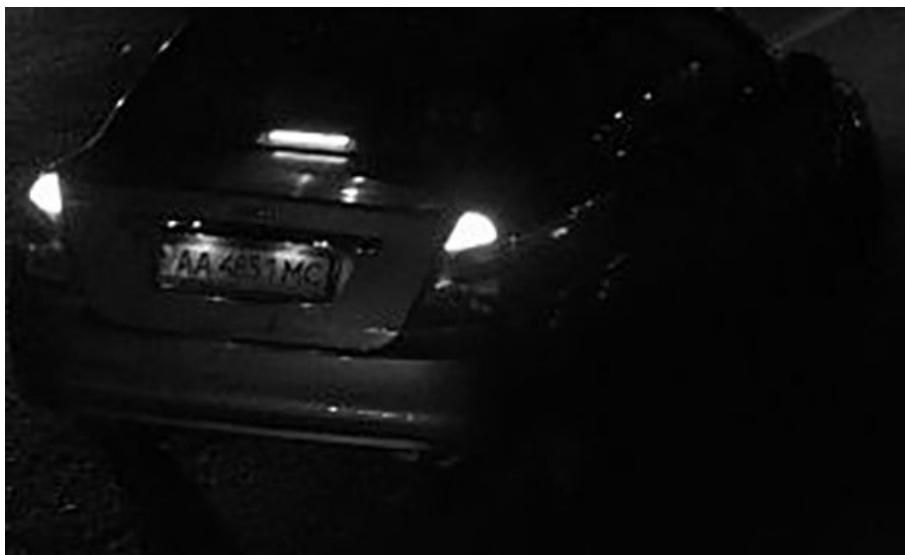
Fig. 18: Luce insufficiente per il riconoscimento della targa
