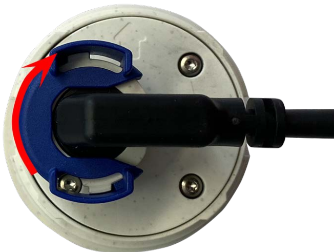
Fig. 28: Lock sensor module cable
