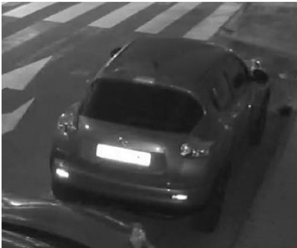
Fig. 17: Matrícula sobreexpuesta debido a luz LED IR demasiado intensa
