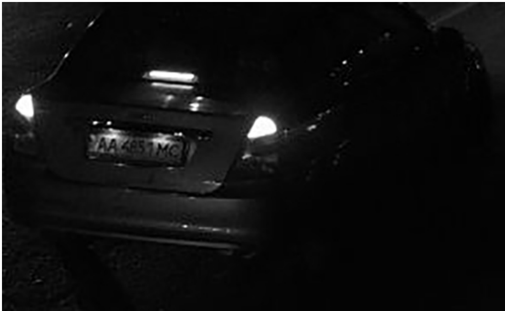
Fig. 18: Luce insufficiente per il riconoscimento della targa
