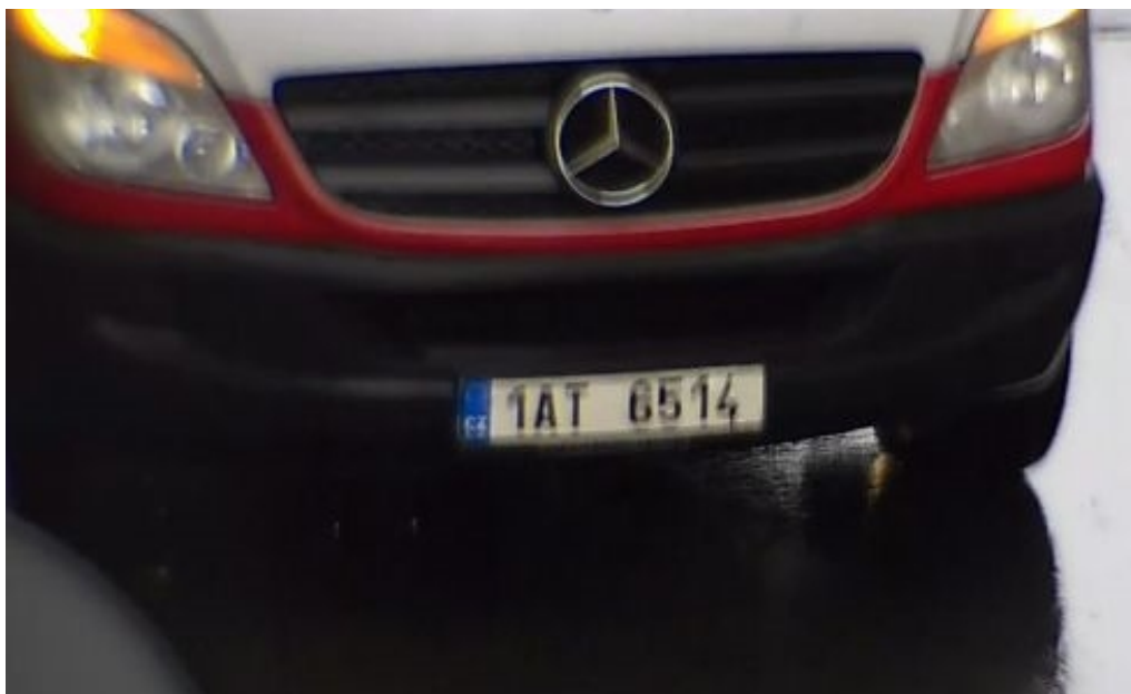
Fig. 15: Targa sfocata a causa di un tempo di esposizione lungo
