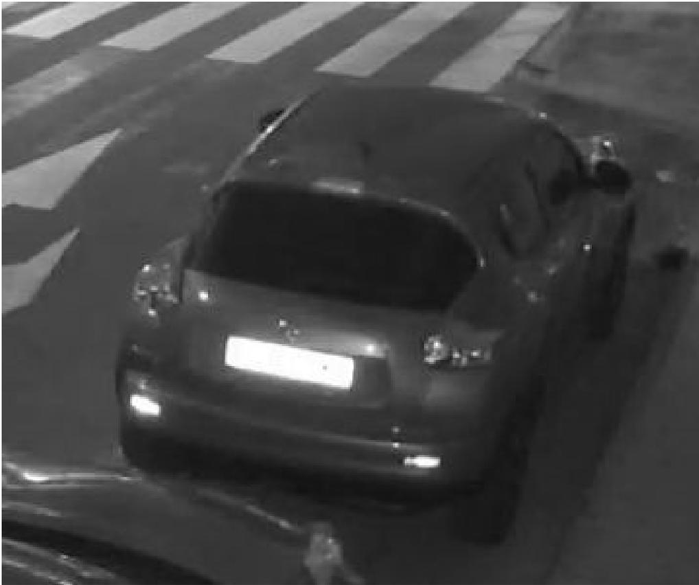
Abb. 15: Überbelichtete Kennzeichen aufgrund zu starken IR-LED-Lichts
