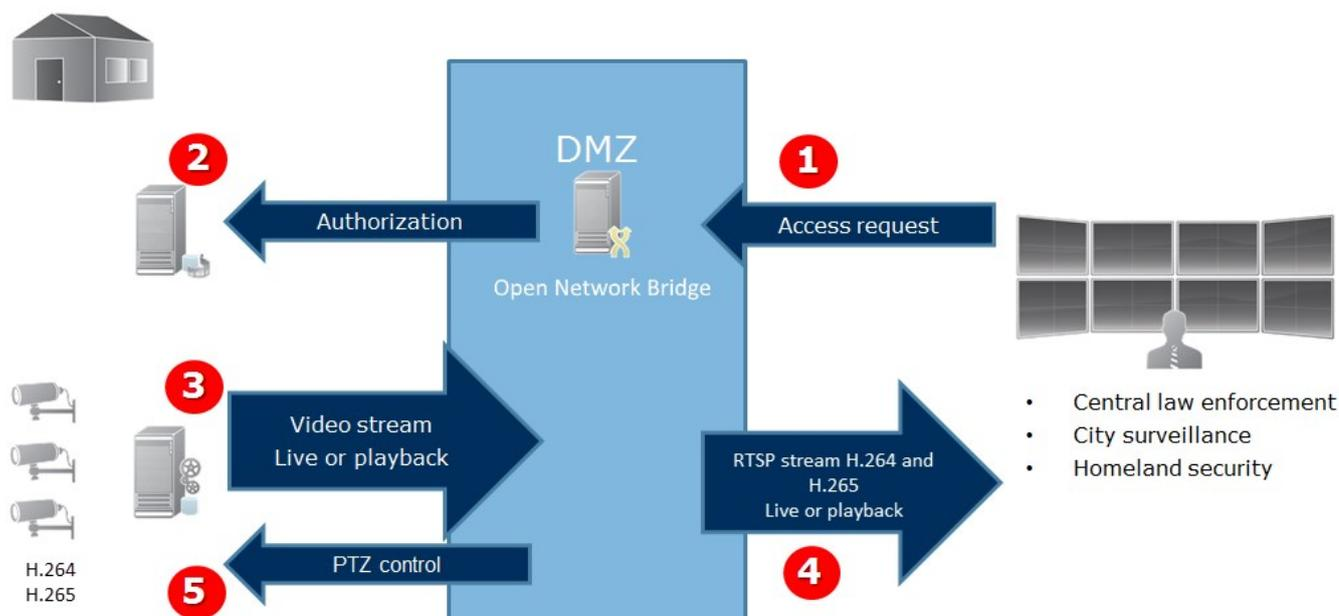
1. ONVIF 客户端通过 MOBOTIX Open Network Bridge 服务器经过互联网连接到 MOBOTIX HUB VMS。为此，ONVIF 客户端需使用已安装 MOBOTIX Open Network Bridge 的服务器的 IP 地址或域名（域/主机名）以及 ONVIF 端口号。
