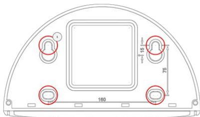
**Fig. 7: Wall Mount con agujeros para colocar los tornillos de fijación**
