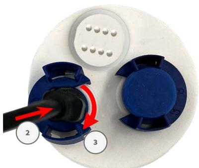
**Fig. 15:** Presione el enchufe firmemente hasta que la junta tórica azul encaje en su sitio.
