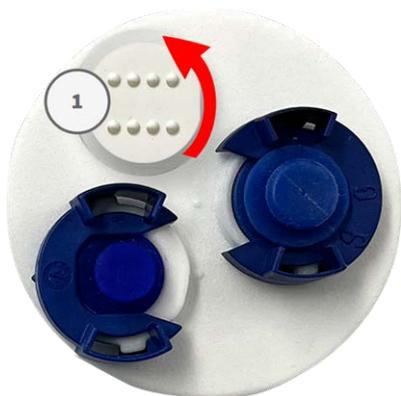
2. Insérez les câbles des périphériques d'E/S dans les ouvertures prévues à cet effet dans la calotte du dôme.
