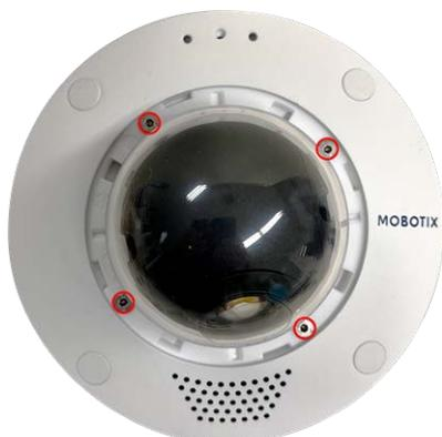
3. Desserrez légèrement les deux vis Allen ① à l'aide de la clé Allen [Accessoires de montage : contenu de la livraison, p. 19](#) de part et d'autre de la monture d'objectif.
