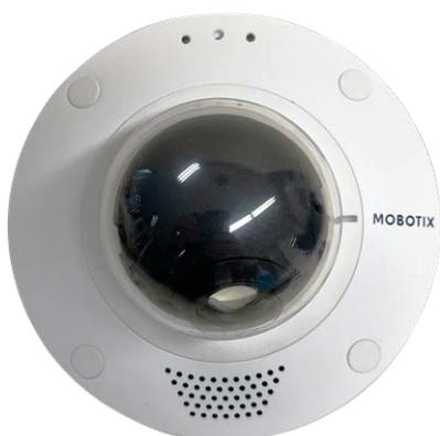
2. Desserrez les quatre vis de fixation de la bague de serrage à l'aide de la clé Allen [Accessoires de montage : contenu de la livraison, p. 19](#) fournie, puis retirez délicatement le dôme.
