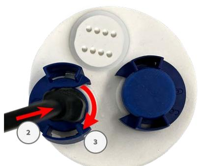
Fig. 15: Appuyez fermement sur la fiche jusqu'à ce que la bague d'étanchéité bleue s'enclenche
