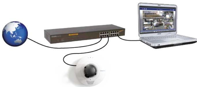
Fig. 16: Alimentation électrique à l'aide d'un commutateur PoE conformément à PoE Plus (802.3at-2009).
