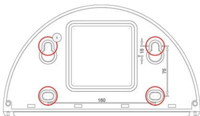
Fig. 7: Wall Mount avec trous pour le positionnement des vis de fixation
