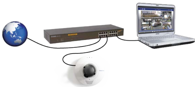
Fig. 16: Alimentazione tramite interruttore PoE in base allo standard PoE Plus (802.3at-2009).
