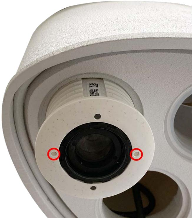
Abb. 22: Sensormodul entriegeln
