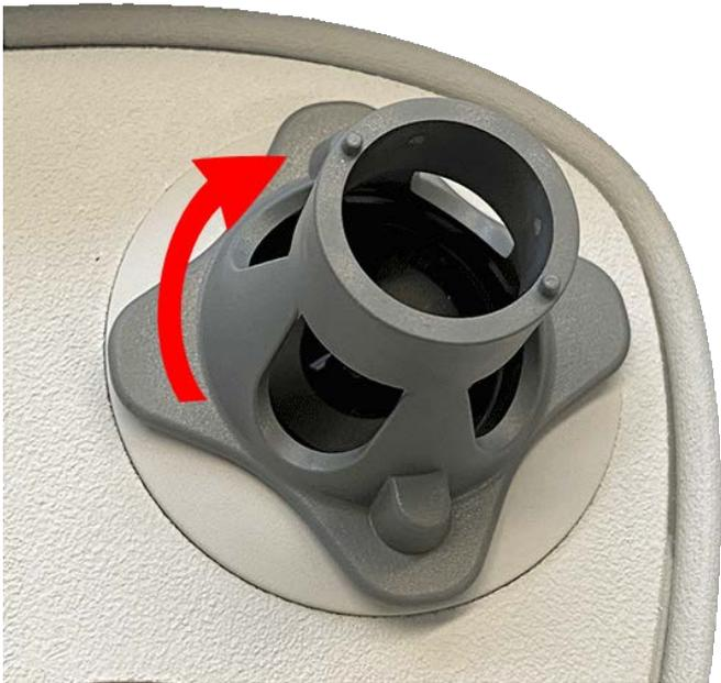
**Abb. 26: Sensormodul verriegeln**
