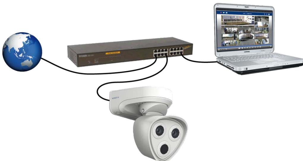
Abb. 51: Stromversorgung über PoE-Switch gemäß PoE Plus (802.3at-2009).
