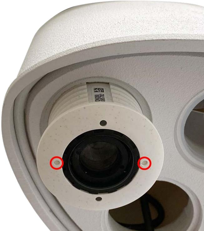
Abb. 12: Sensormodul in Modulgehäuse einsetzen
