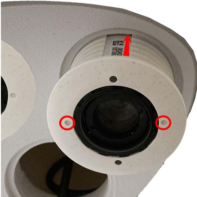
Abb. 25: Sensormodul in Thermal-Frontplatte einsetzen
