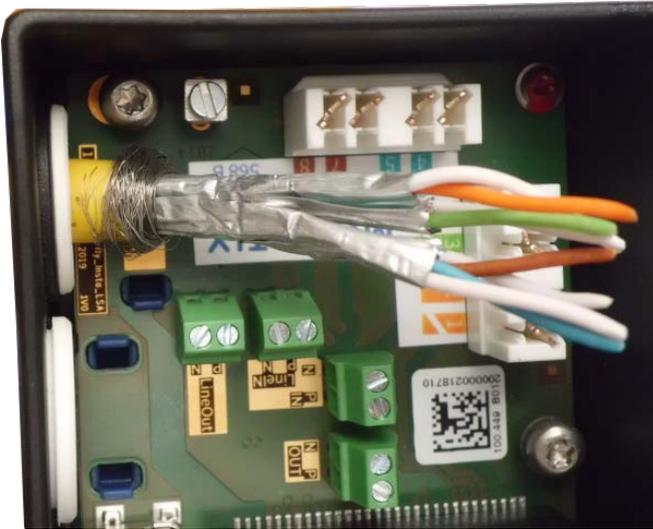
Abb. 56: Netzwerkkabel eingesteckt, Stopfen richtig eingesetzt
