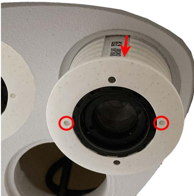
Abb. 23: Sensormodul aus Modulgehäuse entfernen
