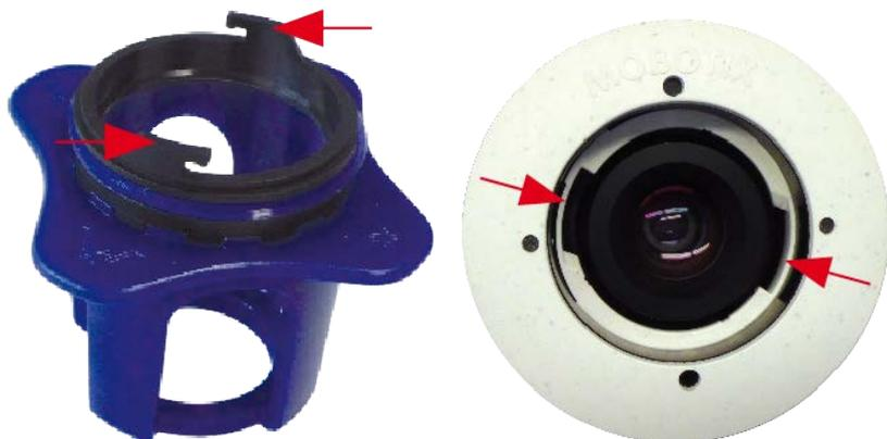
**Fig. 86:** Inserte el cristal de protección del objetivo con la llave de objetivo
