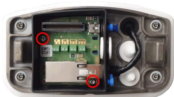
Fig. 66: Monte el Connector Box RJ45 (imagen superior) con los dos tornillos (resaltados en rojo) en la placa de montaje
