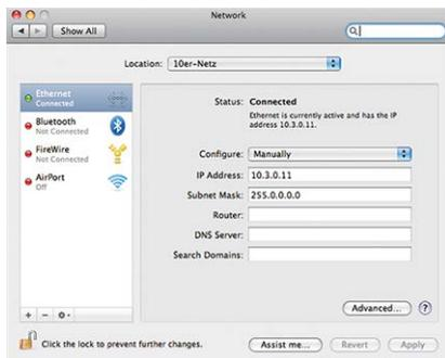
Fig. 77: Configuración de red en equipos MacOS
