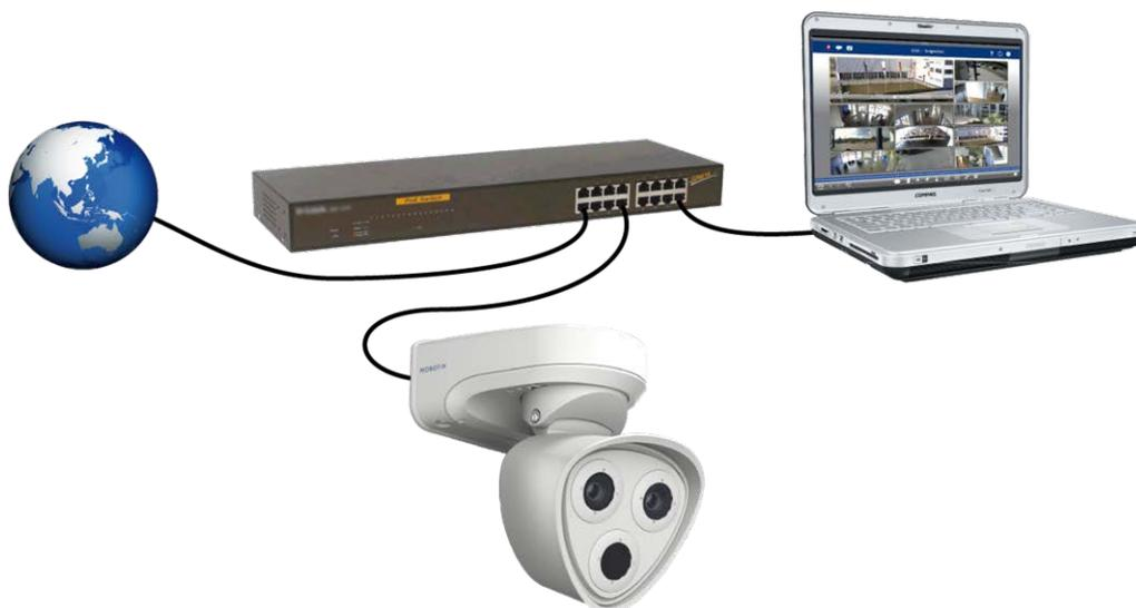
Fig. 51: Fuente de alimentación mediante un conmutador PoE según la PoE Plus (802.3at-2009)
