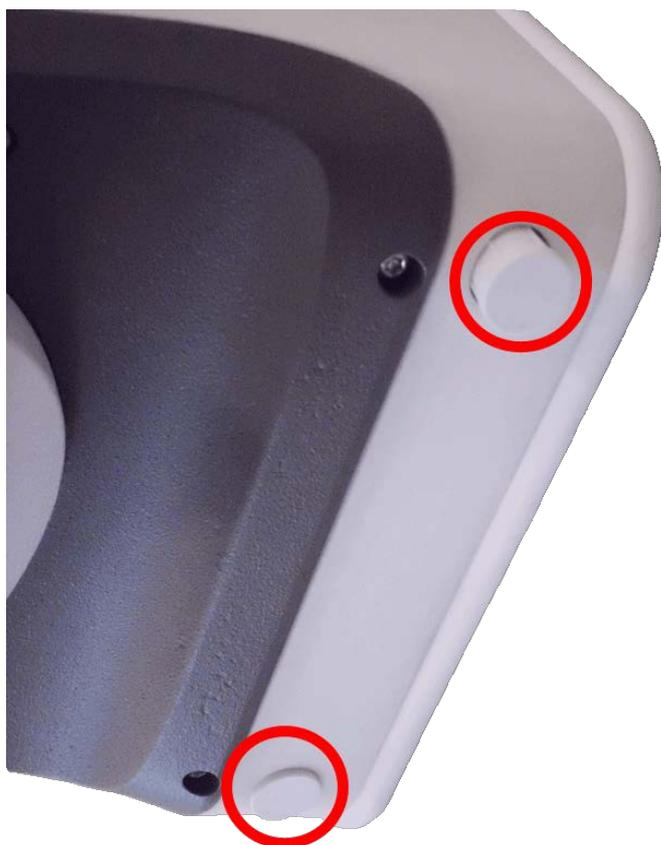
**Fig. 71: Coloque los tapones de caucho**
