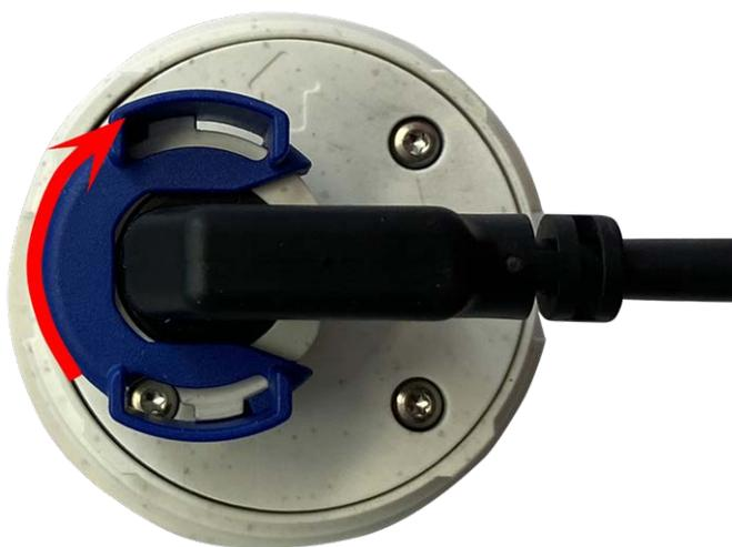
Fig. 28: Bloquee el cable del módulo del sensor
