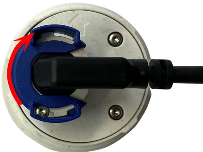
Fig. 11: Bloquee el módulo de sensor
