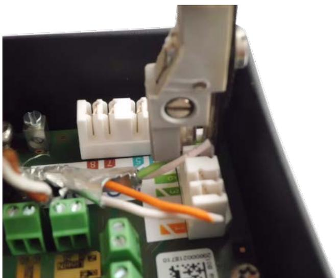
Fig. 59: Cables de red conectados mediante la herramienta LSA+/Krone
