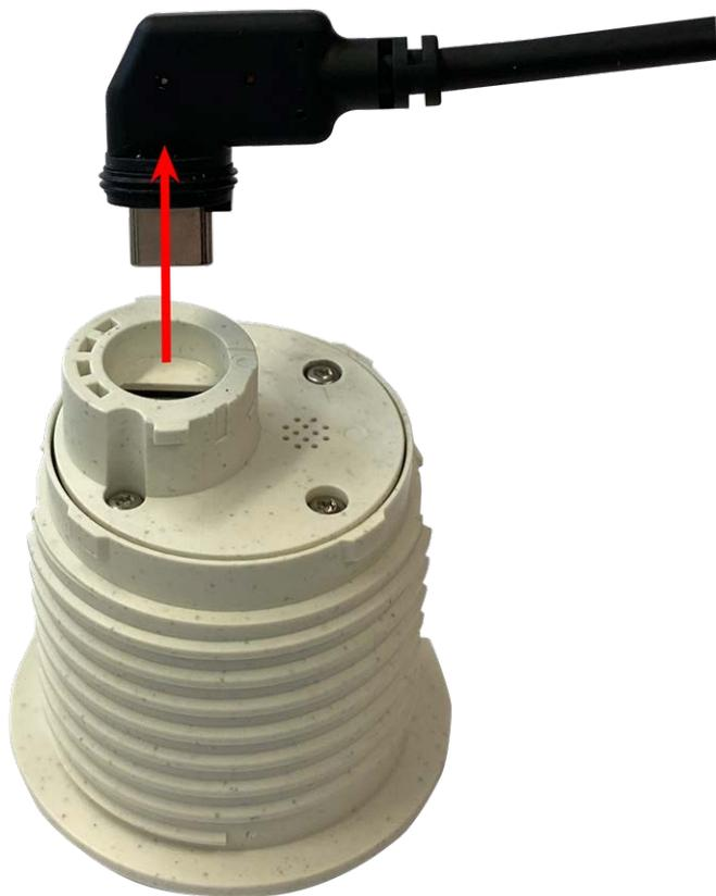
Fig. 21: Extracción del cable del módulo de sensor
