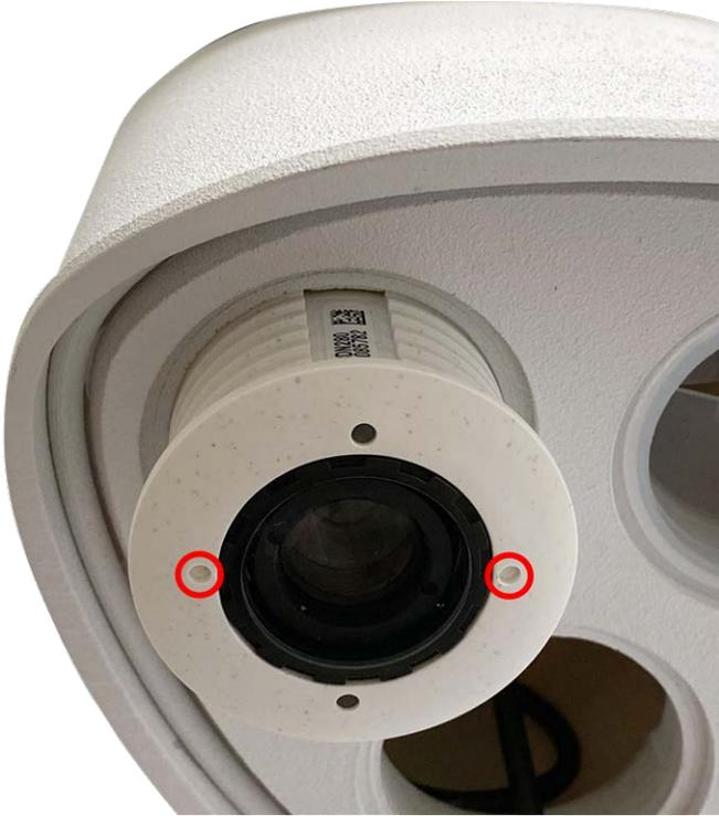
Fig. 22: Desbloqueo del módulo de sensor
