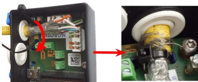
Fig. 57: Brida introducida debajo del cable de red
