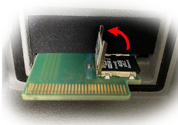
Fig. 95: Desbloquee el soporte de la tarjeta microSD
