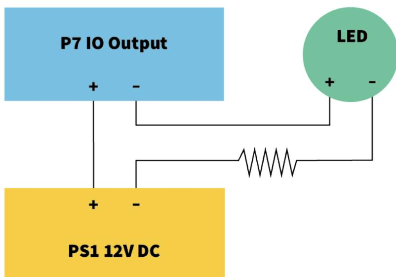
Fig. 67: Ejemplo: encendido de un LED
