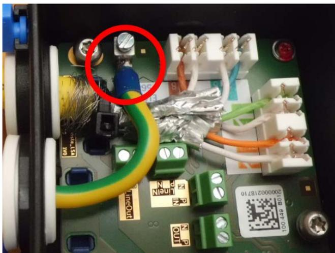
Fig. 62: Cable de tierra conectado al borne
