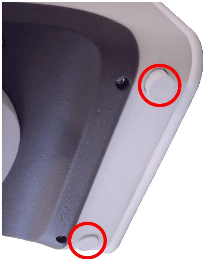
Fig. 91: Retire los tapones de caucho
