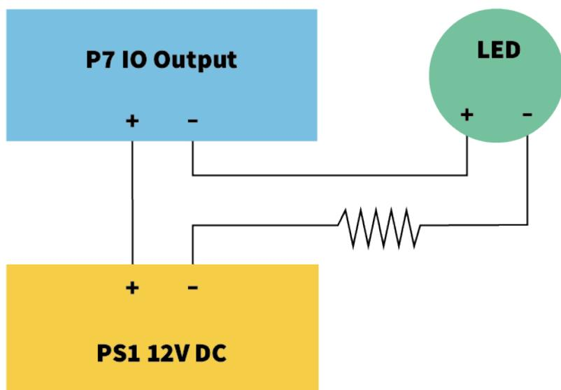
Fig. 67: Exemple : commutation d'une LED
