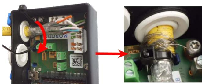
Fig. 57: Serre-câble inséré sous le câble réseau
