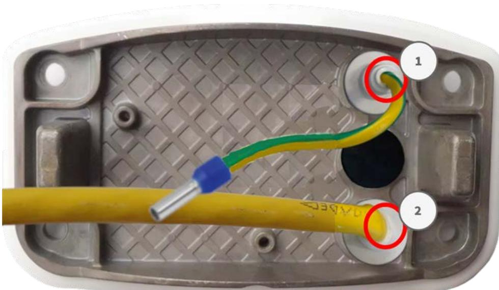
Fig. 48: Plaque de montage avec fil de terre et câble réseau
