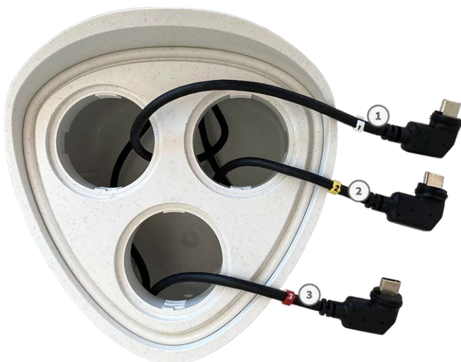
Fig. 8: Cavi del modulo sensore numerati
