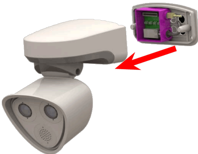
Fig. 93: Estrarre il corpo della telecamera dalla piastra di montaggio
