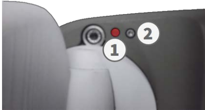
Fig. 74: Vista della M73 dal basso con LED ① e vite con guarnizione ② che nasconde il tasto all'interno del corpo della telecamera
