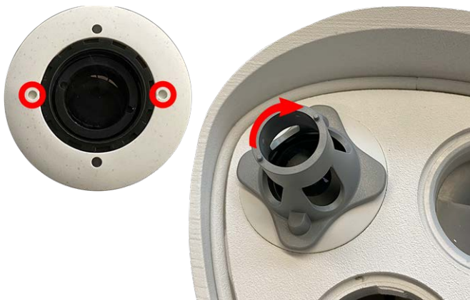
Fig. 13: Bloccare il modulo sensore
