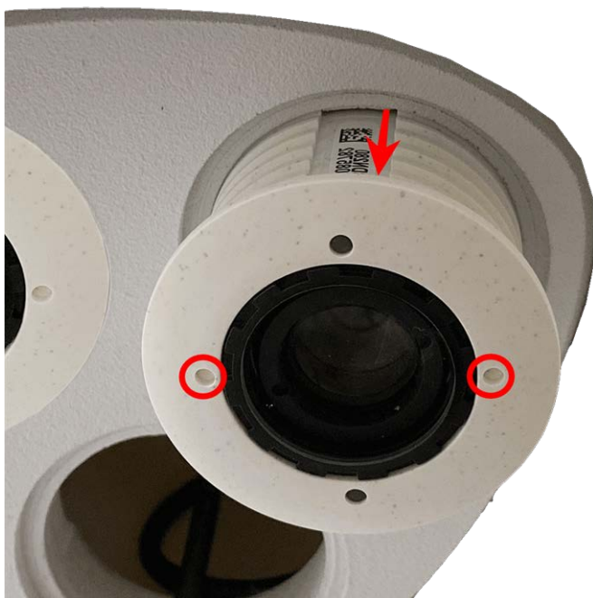
Fig. 23: Rimuovere il modulo sensore dall'alloggiamento del modulo
