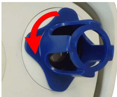
Fig. 83: Ruotare il modulo sensore in senso antiorario fino all'arresto
