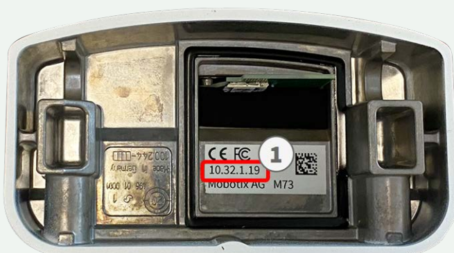
Fig. 5: Indirizzo IP sul retro dell'alloggiamento della telecamera
