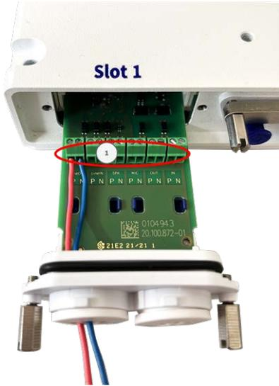
Fig. 33: Fils d'E/S connectés à la borne
