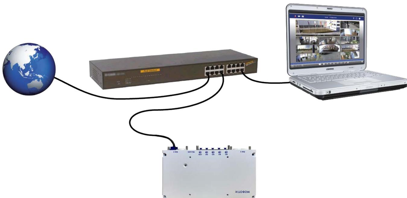
Fig. 40: Alimentation électrique à l'aide d'un commutateur PoE conformément à PoE Plus (802.3at-2009)
