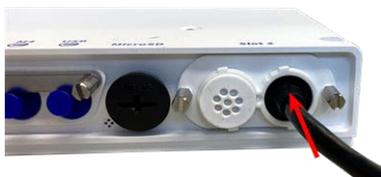
Fig. 41: Appuyez fermement sur la fiche jusqu'à ce que la bague d'étanchéité bleue s'enclenche
