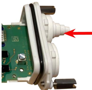
3. Insérez le câble réseau dans le bouchon en caoutchouc blanc :
