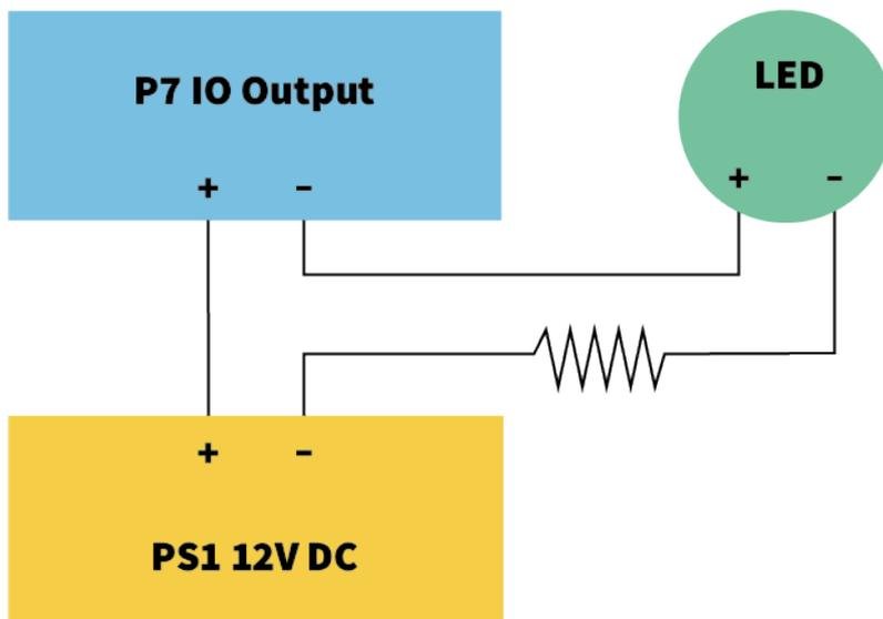
**Fig. 35: Exemple : commutation d'une LED**
