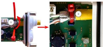
Fig. 24: Serre-câble inséré sous le câble réseau
