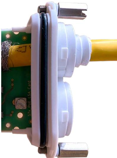
Fig. 23: Câble réseau inséré, bouchon correctement installé
