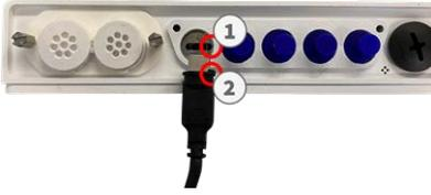
**ATTENTION!** Si le câble du module n'est pas branché correctement, la caméra ne reconnaît pas le capteur.
