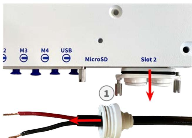
2. Insérez le câble d'alimentation dans le bouchon en caoutchouc à un fil blanc.
