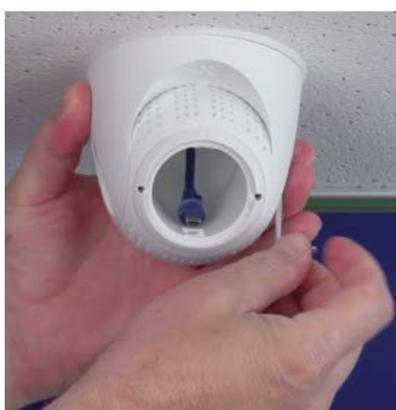
7. Allentare le due viti di fissaggio dell'inserto ① , quindi ruotare l'inserto in modo che la piccola barra opposta all'etichetta **TOP/OBEN** sia rivolta verso il foro della vite di riferimento ② .
