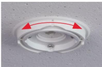
4. Far passare con cautela il cavo del sensore attraverso la guarnizione, l'anello girevole e la piastra di base.
