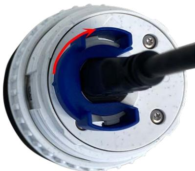
Fig. 12: Bloccare il cavo del modulo sensore
