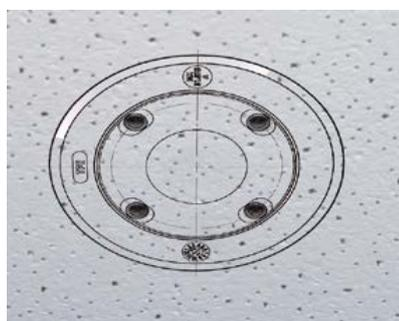
5. Al centro della dima di foratura, praticare un altro foro nella parete o sulla piastra frontale del cavo del modulo sensore. Il foro deve avere un diametro compreso tra 15 e 35 mm.
