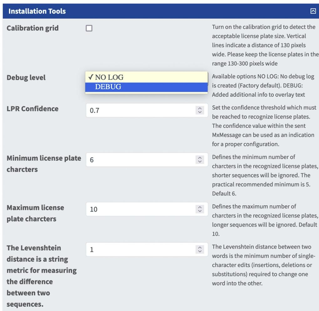
Fig. 27: Scheda "Installation Tools" (Strumenti di installazione)
