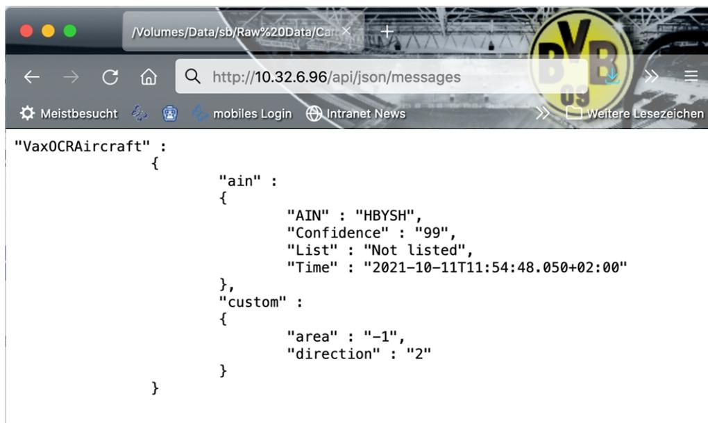
**Fig. 30: Esempio: metadati trasmessi all'interno di un MxMessage dell'applicazione Vaxtor Aircraft Identification Number Recognition App**
