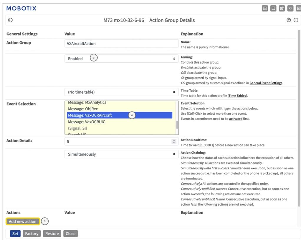
Fig. 26: Configurazione di un gruppo di azioni
