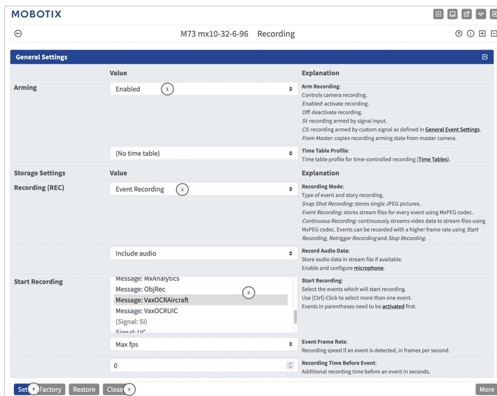
**Fig. 28:** Configurazione delle impostazioni di registrazione della telecamera
