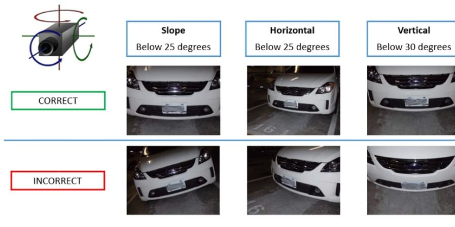
Abb. 11: Maximaler Drehungswinkel
