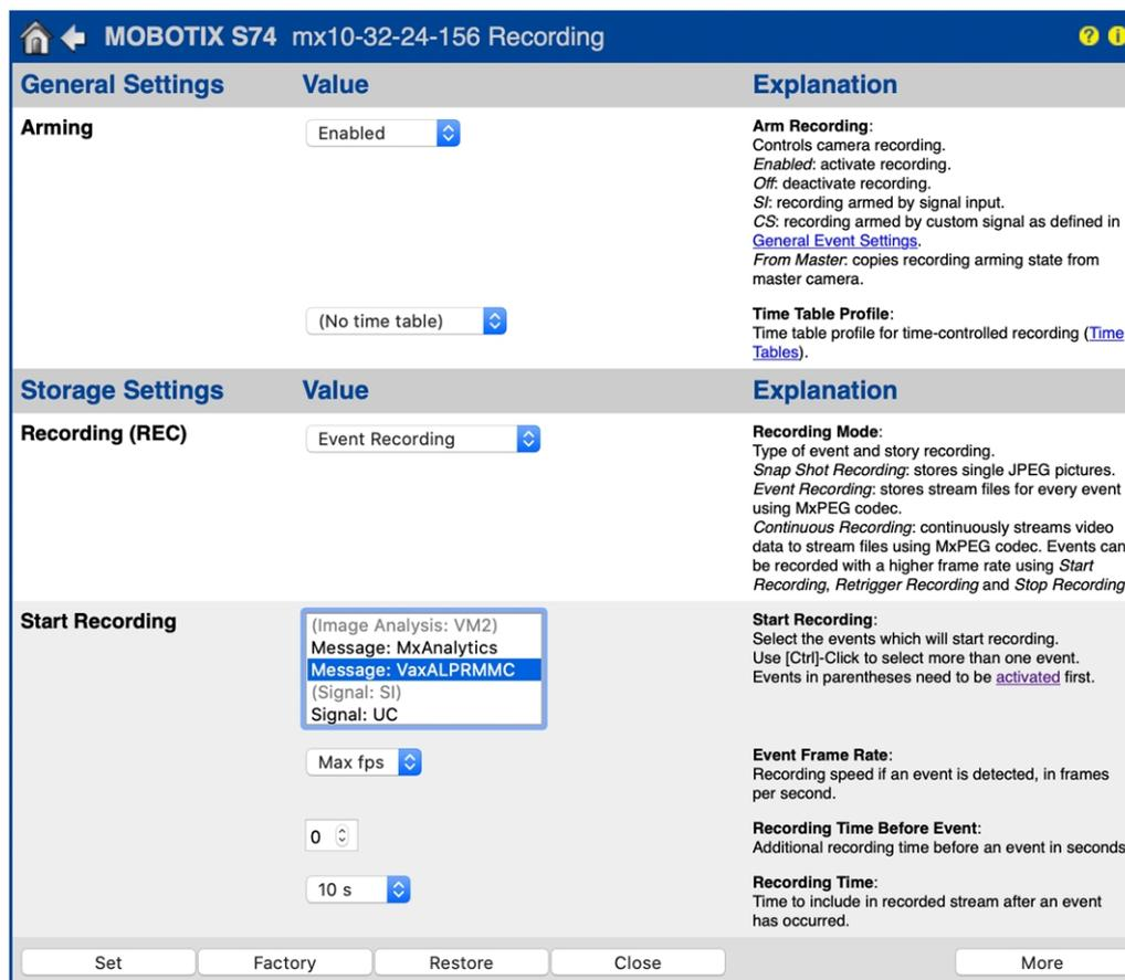
Abb. 27: Konfiguration der Aufnahmeeinstellungen der Kamera
