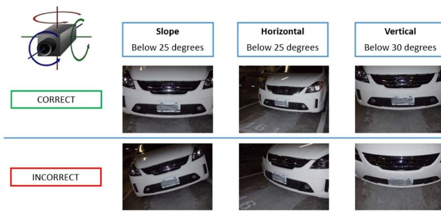
Fig. 11: Angle de rotation maximal
