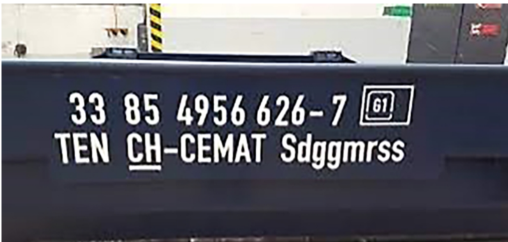
Fig. 31: Código UIC en un vagón ferroviario
