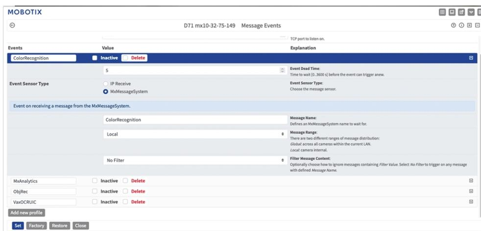
Fig. 13: Exemple : Détails d'événement de message générique - aucun filtre
