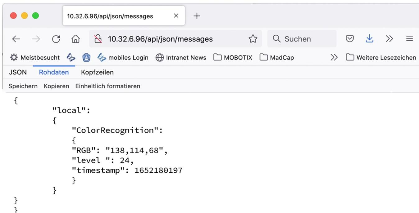
Fig. 18: Exemple : Métadonnées transmises dans un message MxMessage de Mx Color Recognition App
