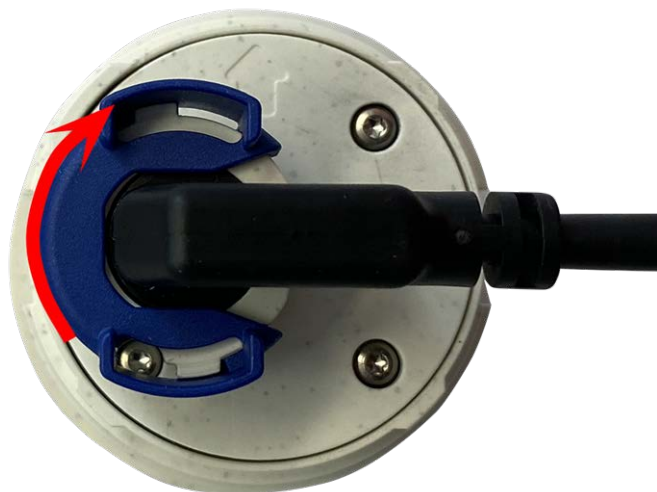
Fig. 12: Lock sensor module
