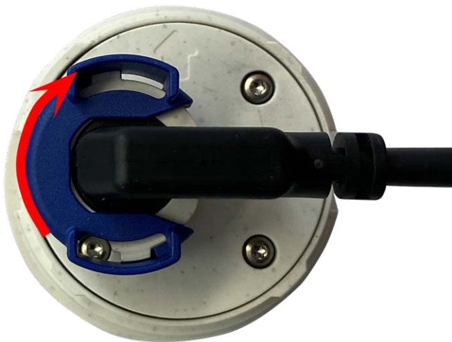
Fig. 29: Lock sensor module cable
