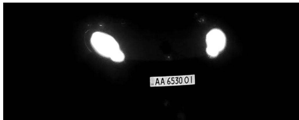
Fig. 11: Targa facilmente leggibile di notte con un'illuminazione LED a infrarossi
