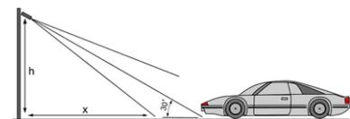
Fig. 12: Pointage vertical de la caméra
