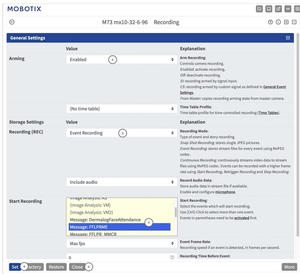
Fig. 34: Configuration des paramètres d'enregistrement de la caméra
