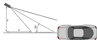
Fig. 13: Alignement horizontal de la caméra
