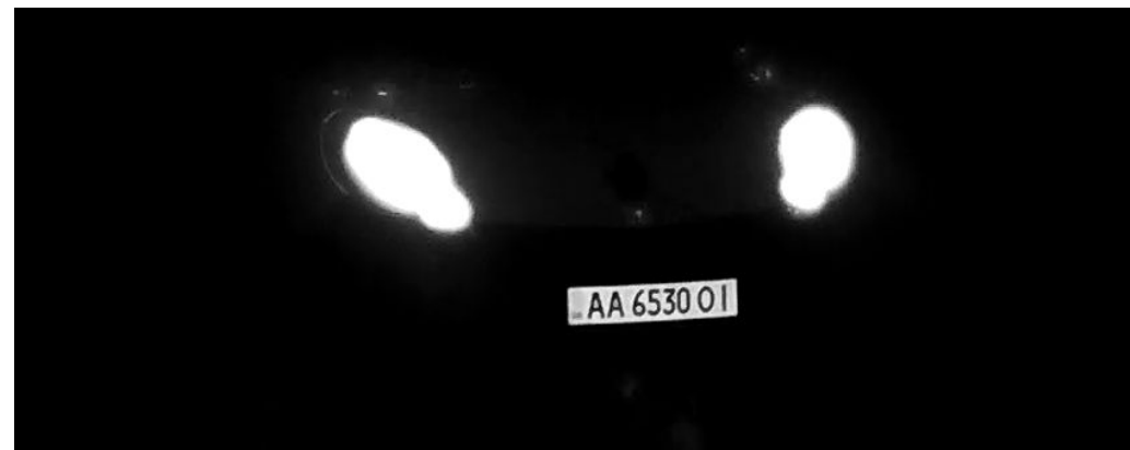
Abb. 11: Gut lesbares Kennzeichen bei Nacht mit Infrarot-LED-Beleuchtung
