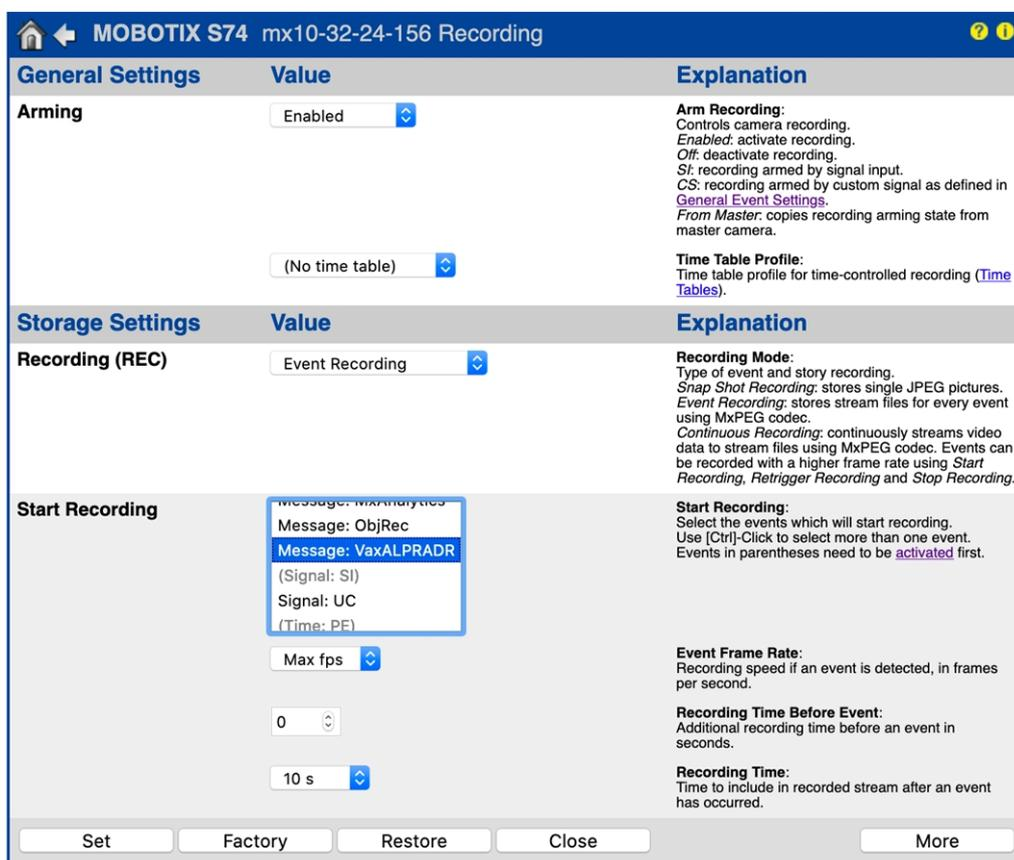
Fig. 26: Configuration des paramètres d'enregistrement de la caméra
