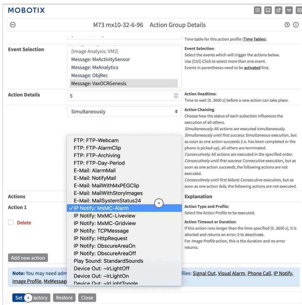
Fig. 28: Sélectionner le type et profil d'action.
