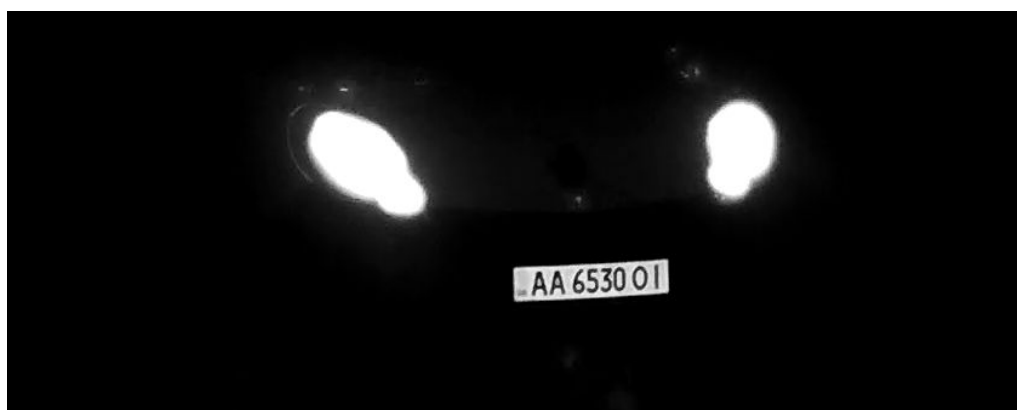
Fig. 11: Plaque d'immatriculation facilement lisible de nuit avec un éclairage LED infrarouge
