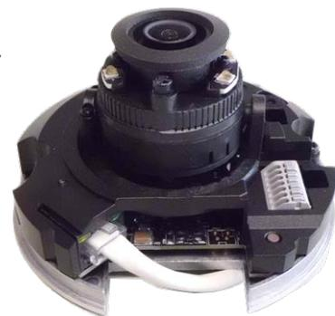
6. Richten Sie die zwei Löcher für die Schrauben der Kamera am Montageort an den Bohrungen für die Kunststoffdübel aus. Befestigen Sie die Kamera mit den im Lieferumfang enthaltenen selbstschneidenden Schrauben.
