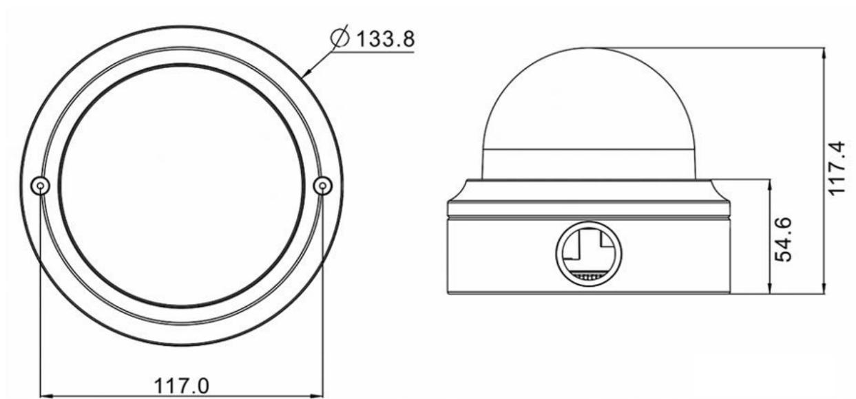
Fig. 1: Caméra dôme fixe anti-vandale 2MP avec analyse vidéo : toutes les mesures sont en mm
