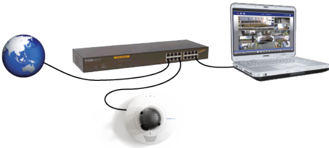
Abb. 17: Stromversorgung über PoE-Switch gemäß PoE Plus (802.3at-2009).
