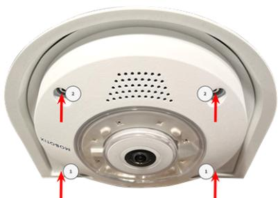
11. Introduzca los tapones de caucho [M.7, p. 20](#) en los agujeros para tornillos de la cámara (① y ② en la figura anterior).
