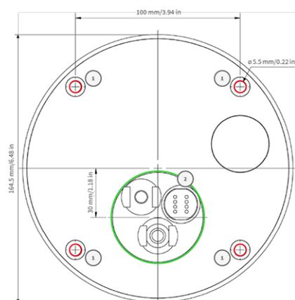
**Fig. 7: Plantilla de perforación con agujeros para colocar los tornillos de fijación (círculos rojos) y para la toma de corriente de montaje empotrado (círculo verde)**
