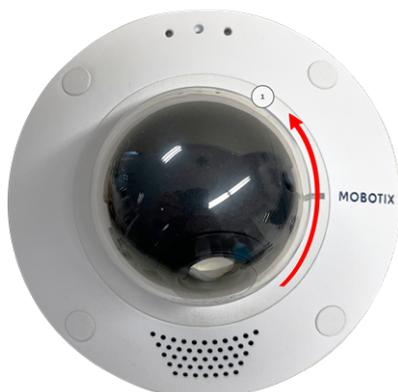
2. Afloje los cuatro tornillos de fijación del anillo de sujeción con la llave Allen [Materiales de montaje: Alcance de la entrega, p. 19](#) suministrada [Materiales de montaje: Alcance de la entrega, p. 19](#) y, a continuación, tire con cuidado de la cúpula.
