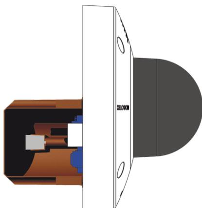
Fig. 6: Vista lateral de MOBOTIX D71 sobre la toma de corriente de montaje empotrado
