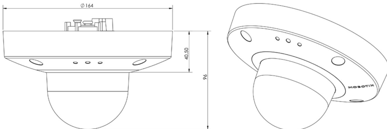
Fig. 5: MOBOTIX D71: Todas las medidas en mm
