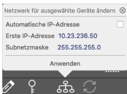
Fig. 25: Cambiar red para los dispositivos seleccionados
