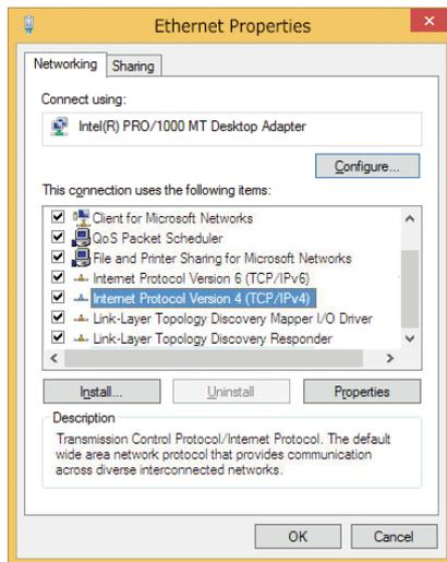
**Fig. 19: Configuración de red en equipos Windows**
