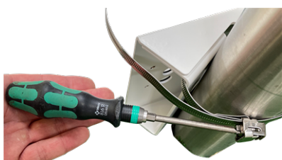
Fig. 14: Serrez les sangles
